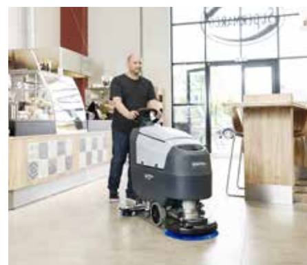
Nilfisk SilenTech™-teknologien reducerer støjniveauet fra 65 dB(A) – og helt ned til 60 dB(A) ved støjsvag rengøring
